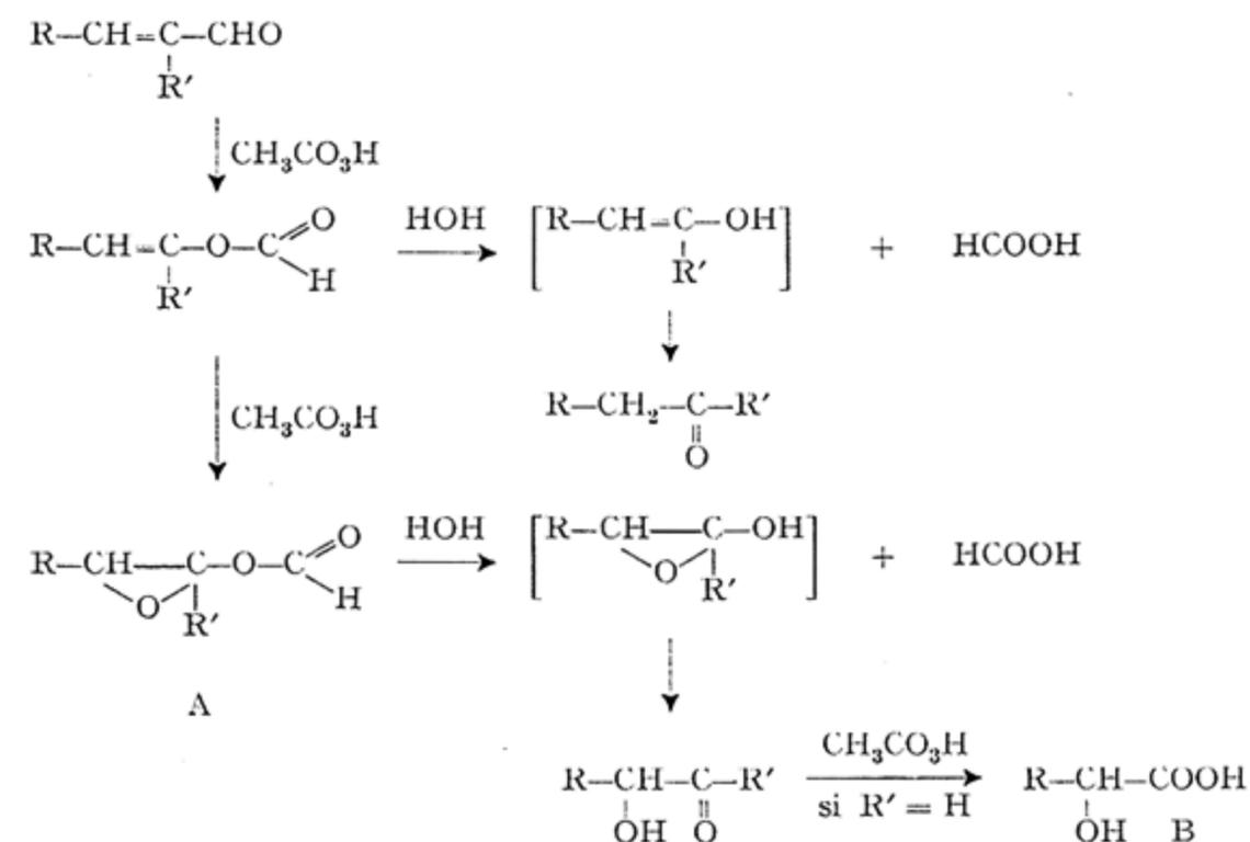
Si  $\text{R}' = \text{H}$ , le produit de l'hydrolyse du formiate d'époxyalcoyle<sup>2)</sup> est un  $\alpha$ -hydroxyaldéhyde saturé qui, par oxydation, aboutit à l'acide correspondant (exemples: acides lactique et mandélique).
